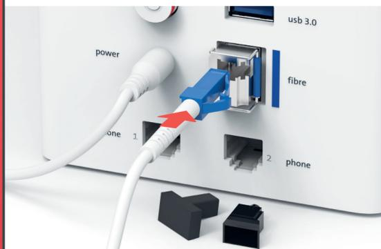
Tu dois d'abord retirer avec précaution les embouts noirs aux deux extrémités du câble fibre optique, ainsi que l'embout présent sur le slot « fibre ».
