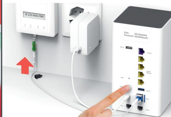
Branche le câble avec l'embout vert sur la prise fibre optique – le SMS te dit où. En général, c'est la prise 2 (port 2).
