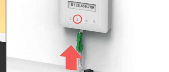
Nur ein Steckplatz funktioniert: Nimm die Schutzkappe ab. Öffne bei der Glasfasersteckdose den vorgegebenen Steckplatz (in der Regel «2», selten «1»). Achtung: Falls deine Anschlüsse gegen oben montiert sind, ist Steckplatz 2 der zweite von rechts. Zum Entfernen des Kabels siehe Rückseite. **1**
