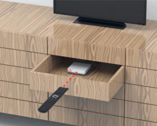
La télécommande et la TV-Box sont reliées entre elles par Bluetooth. Les deux appareils ne nécessitent pas de contact visuel. Alors départ dans l'armoire en bois, évite les parois métalliques.
